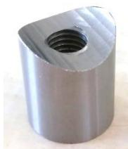
電気自動車の部品です。旋盤とフライス盤で製作しました。パイプ側面に取り付け、中央のネジ部に他の部品を固定します。パイプに接する面はR加工しました。機械研究部なら、こんな加工も汎用工作機械でできちゃいます。
